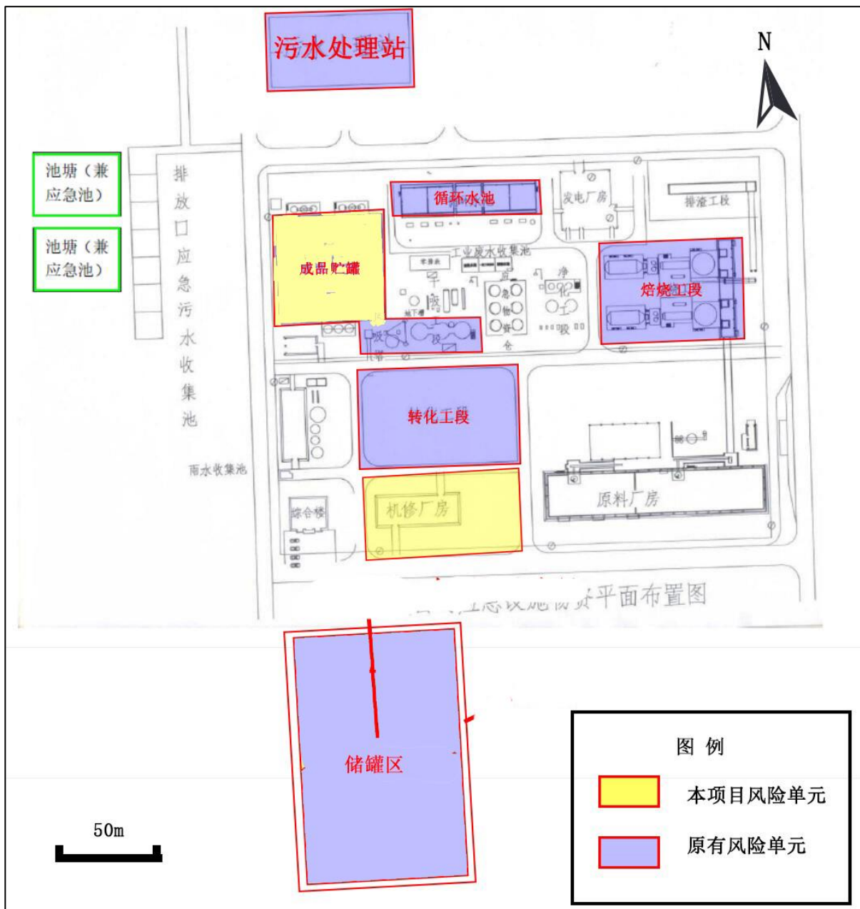
图 7.7-1 本项目极端情况废水处理事宜图及与应急池与原有风险单元位置关系图
